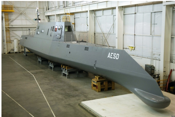
Рис. 1. Експериментальне судно Sea Jet із композитних матеріалів
